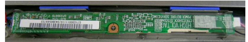
Une solide protection de caoutchouc constitue un mur protecteur autour de l'inverseur.
