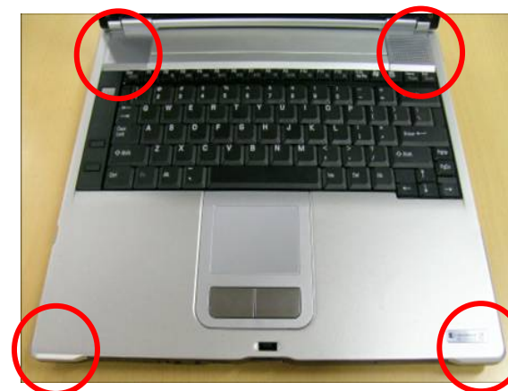
Les angles saillants, une conception clé du dispositif antichoc Toshiba qui offre plus d'espace pour l'absorption des chocs.
