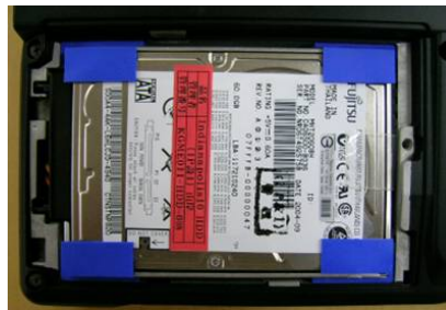
Des languettes en caoutchouc disposées autour du lecteur de disque dur améliorent l'amortissement de l'appareil. Ce dispositif est au cœur du système Shock Protection Design de Toshiba.
