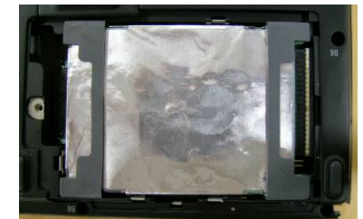
Un matériau antichoc est disposé autour du lecteur de disque dur et agit tel un butoir qui amortit les chocs lors des chutes.
